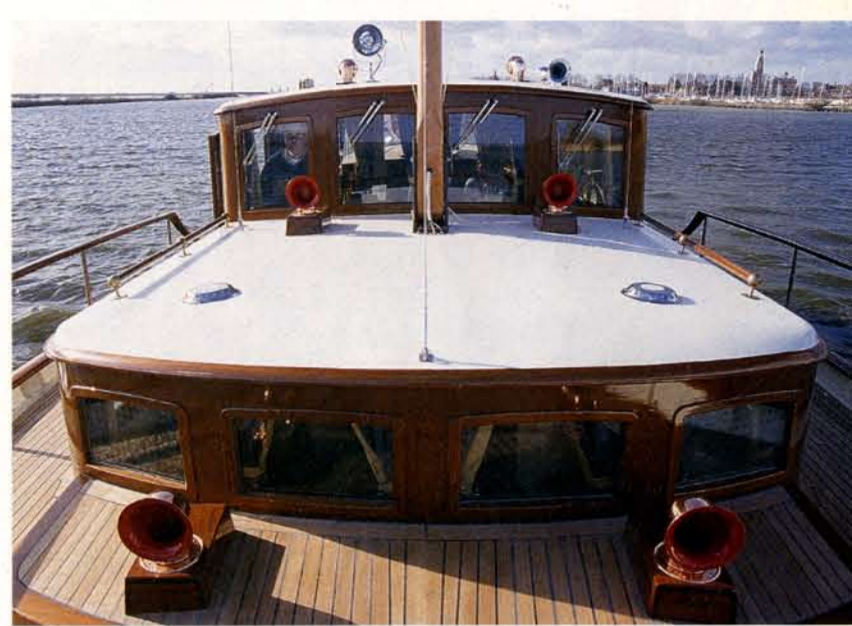
Holz, Holz, Holz: Auf dem Deck der Krabbersbank liegt massives Teak. Die Aufbauten bestehen aus einem Mahagoni-Finish auf Komposit.
